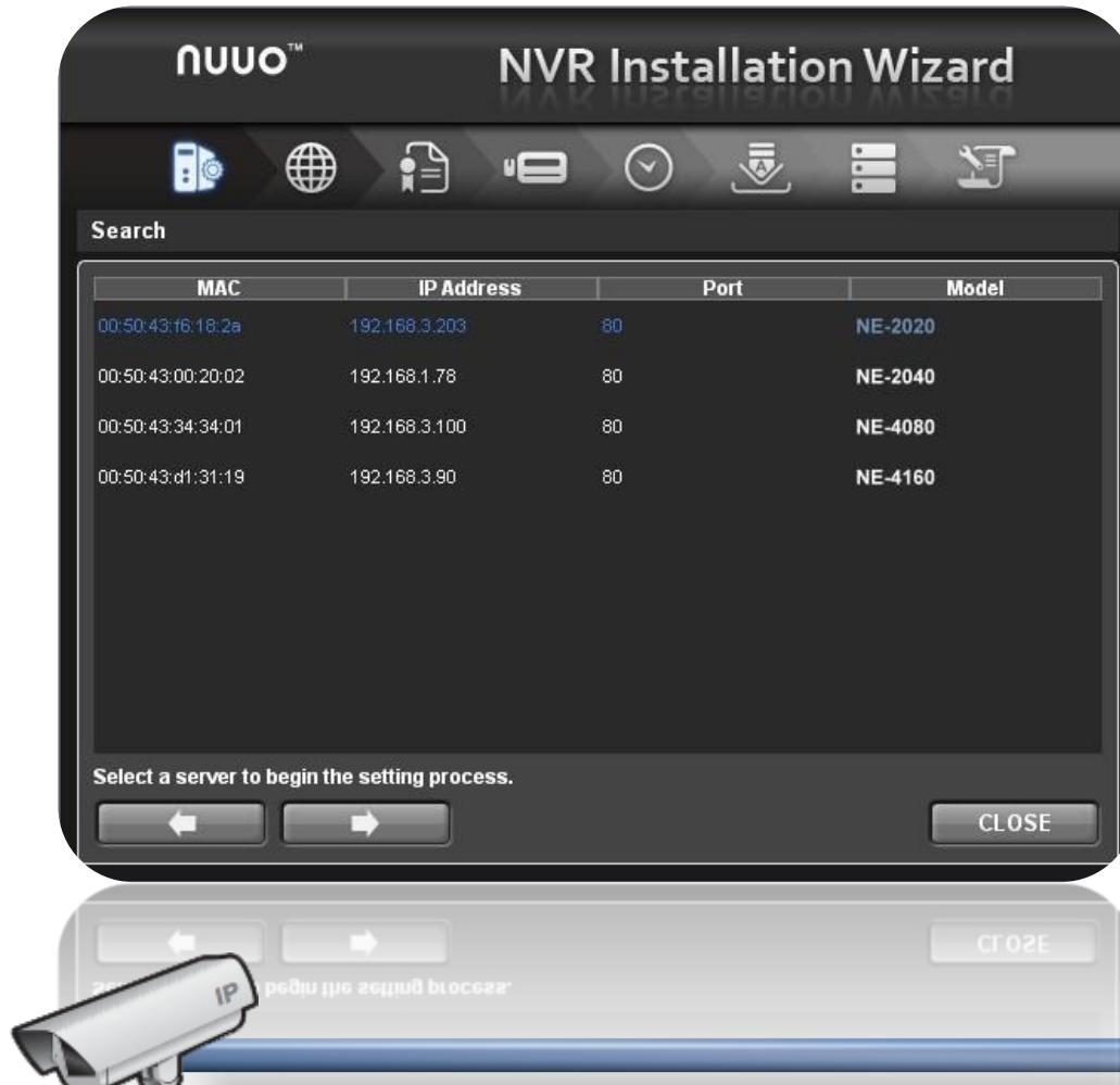
Bei der Ersteinrichtung hilft der Installationsassistent bei IP-Adressierung der NUUO NVRmini 2 Rekordern, bei der Festplattenverwaltung und bei der Integration der IP-Kameras.
